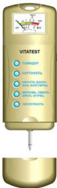
Рис. 8.1. Загальний вигляд персонального портативного електронного нітратометра з аналоговою шкалою "VITATEST" VD-2007
