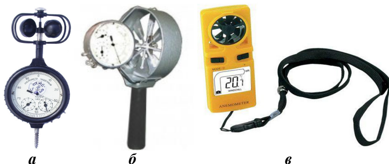
Рис. 3.5. Анемометри: чашковий МС-13 (а); крильчастий із циферблатним реєстратором результатів дослідження АСО-3 (б); крильчастий із дисплейним реєстратором результатів дослідження "La Crosse" WS9500 (в)
