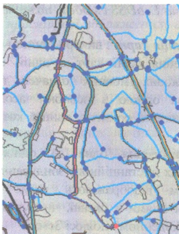
Рис. 7.25. Фрагмент геоінформаційної карти з побудованою мережею доріг та оптимальним за мінімумом відстані маршрутом між двома точками в ГІС "Панорама"
