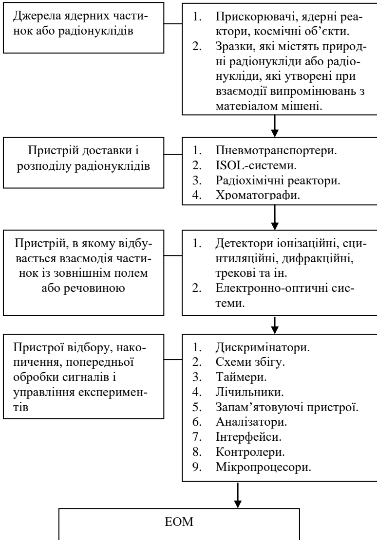
Рисунок 5.5. Блок-схема ядерно-фізичного експерименту
