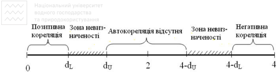
Рис. 6.4. Схема зон автокореляційного зв'язку за критерієм Дарбіна-Уотсона
